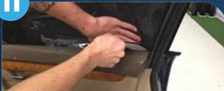
Montez lentement la vitre jusqu'en haut en s'assurant que le film n'a pas bougé. Soulevez le film avec sa protection et mouillez abondamment la vitre en partie basse. Retirez complètement le film de protection sans que le film ne bouge. Vaporisez le film côté adhésif abondamment, mettre en place le bas du film à l'aide de la raclette sous les joints de la vitre ( lècheurs et montant droit et gauche ).
