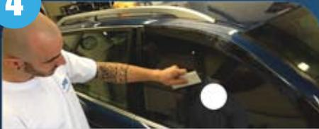
A l'aide de la raclette ( côté noir ), plaquez le film en partie haute en marouflant du centre vers les côtés dans le but de former des tunnels verticaux en partie basse. Si nécessaire formez manuellement les tunnels à la vertical.
