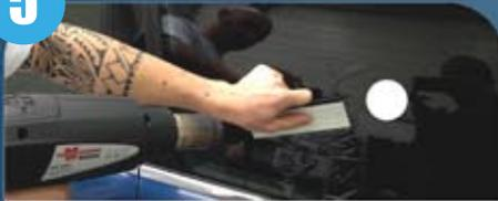
A l'aide du décapeur thermique, thermoformer chaque tunnel, trouvez la bonne distance jusqu'à ce que le tunnel prenne la forme d'un ZIG-ZAG.
