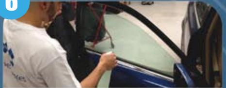
Une fois le thermoformage effectué retirez le film de la vitre afin de la baisser de 4/5 cm, aspergez de solution savonneuse la surface de la vitre extérieur et enfin positionner le film en laissant 1/2 cm de marge en haut et sur le côté du grand montant.
