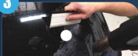
A l'aide du décapeur thermique, thermoformez chaque tunnel, trouvez la bonne distance jusqu'à ce que le tunnel prenne la forme d'un ZIG-ZAG.
